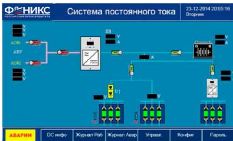
Рисунок 1. Одна группа АКБ и одна группа выпрямительных модулей
